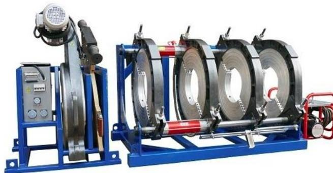
Гидравлический стыковой сварочный аппарат SUD 500-800 Н. Предназначен для монтажа труб из полиэтилена (высокого и низкого давления) и полипропилена.
